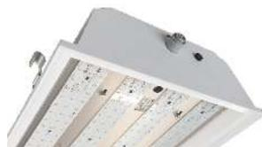
**Apparecchi LED** a tenuta stagna IP65 per ambienti commerciali e industriali per montaggio a soffitto o a sospensione, con diffusione a fascio ampio da 120°. A richiesta tutti gli apparecchi possono essere corredati di lenti speciali con vari spettri luminosi: a fascio stretto 60°-90° per altezze oltre i 9mt; a fascio asimmetrico per illuminazione laterale; o a fascio biasimmetrico per illuminazione bilaterale di scaffali espositivi.
